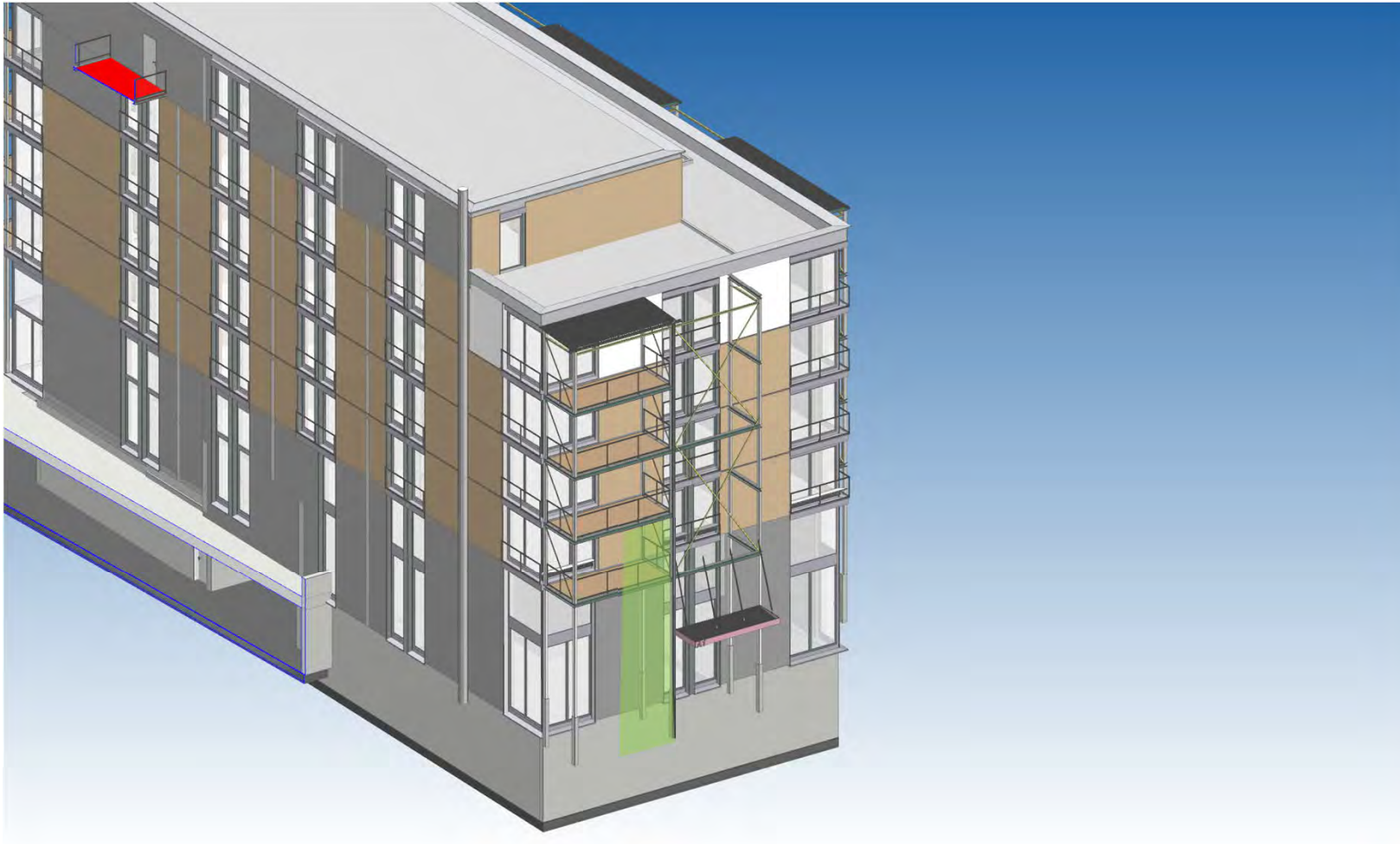
Ansicht Nordfassade in der Axonometrie mit Darstellung der Bereiche mit Rankgerüst (Potenzialbereiche Begrünung)
