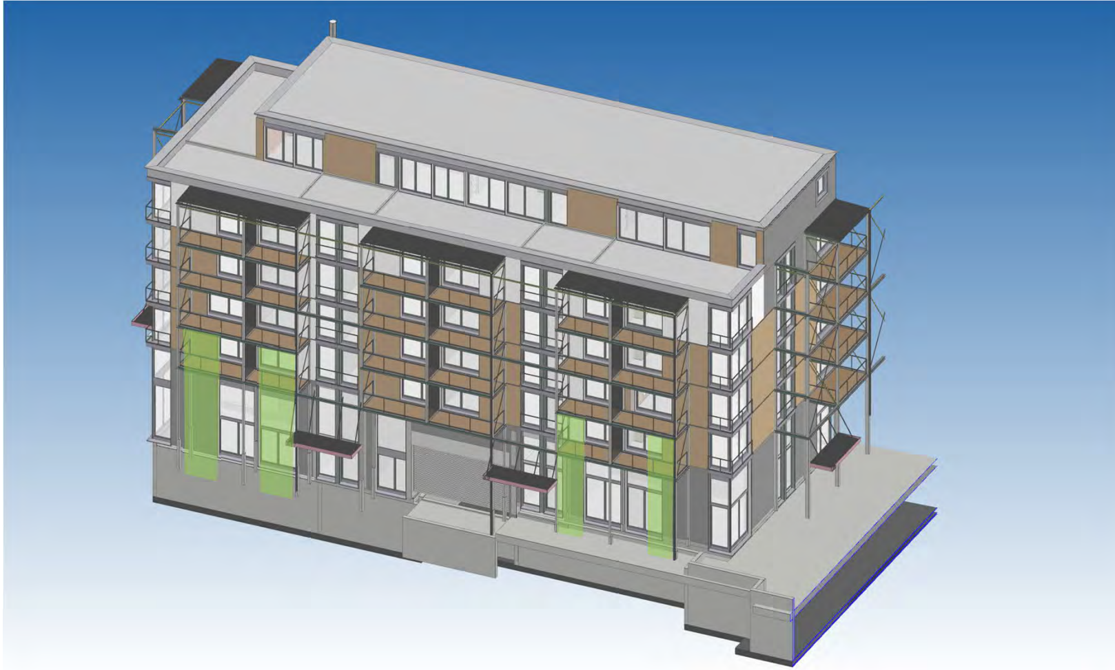
Ansicht Westfassade in der Axonometrie mit Darstellung der Bereiche mit Rankgerüst (Potenzialbereiche Begrünung)
