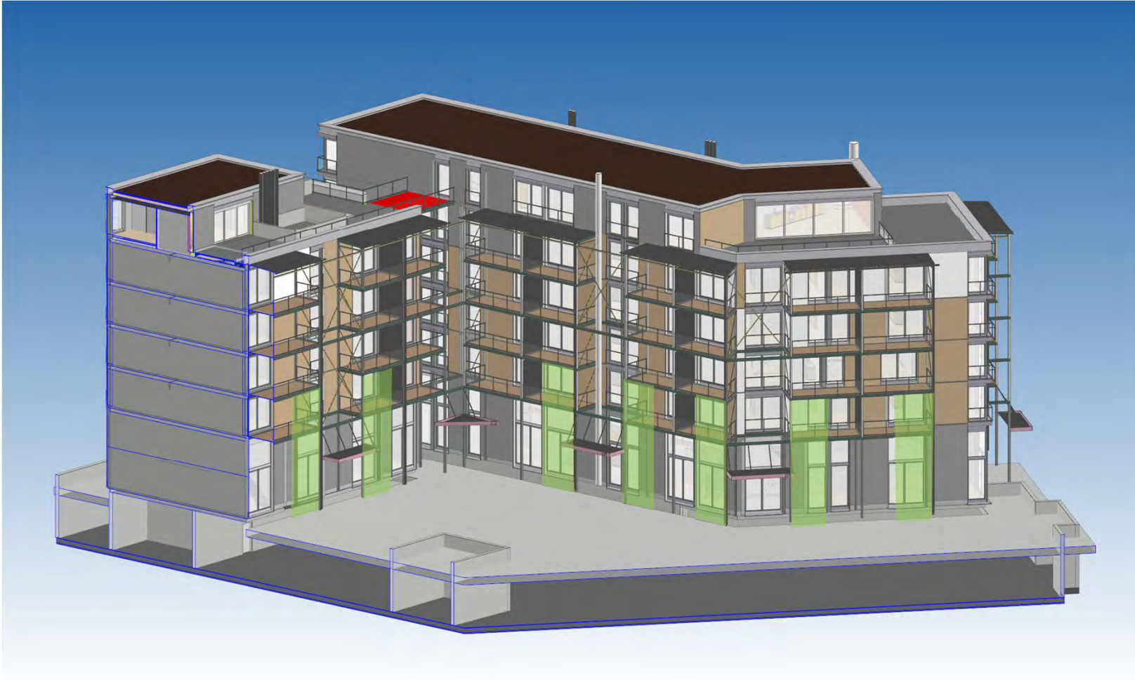
Ansicht Westfassade in der Axonometrie mit flächiger Darstellung der Bereiche mit Rankgerüst (Potenzialbereiche Begrünung)
