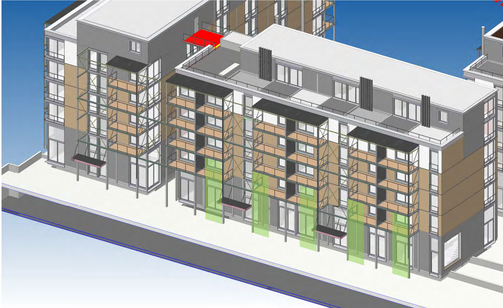
Ansicht Südfassade in der Axonometrie mit Darstellung der Bereiche mit Rankgerüst (Potenzialbereiche Begrünung)
